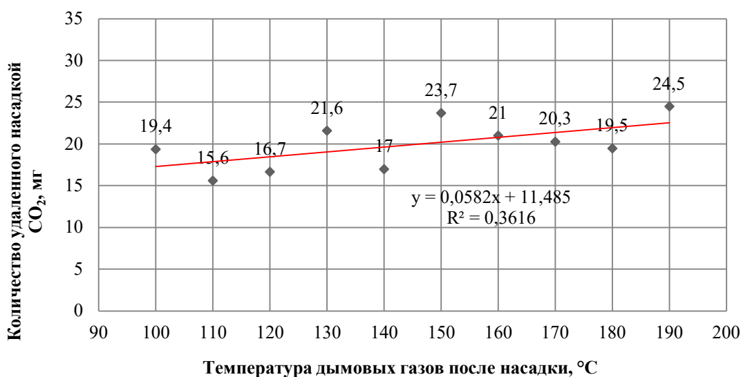
Рис. 5. График зависимости очистки дымовых газов от СО 2 при различной температуре на входе в насадку
