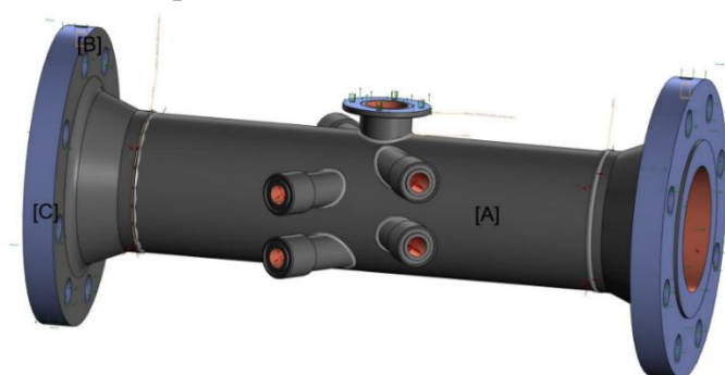
Рис. 3. Закрепление корпуса промышленного счетчика газа
