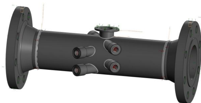
Рис. 2. Трёхмерная модель корпуса промышленного счетчика газа
